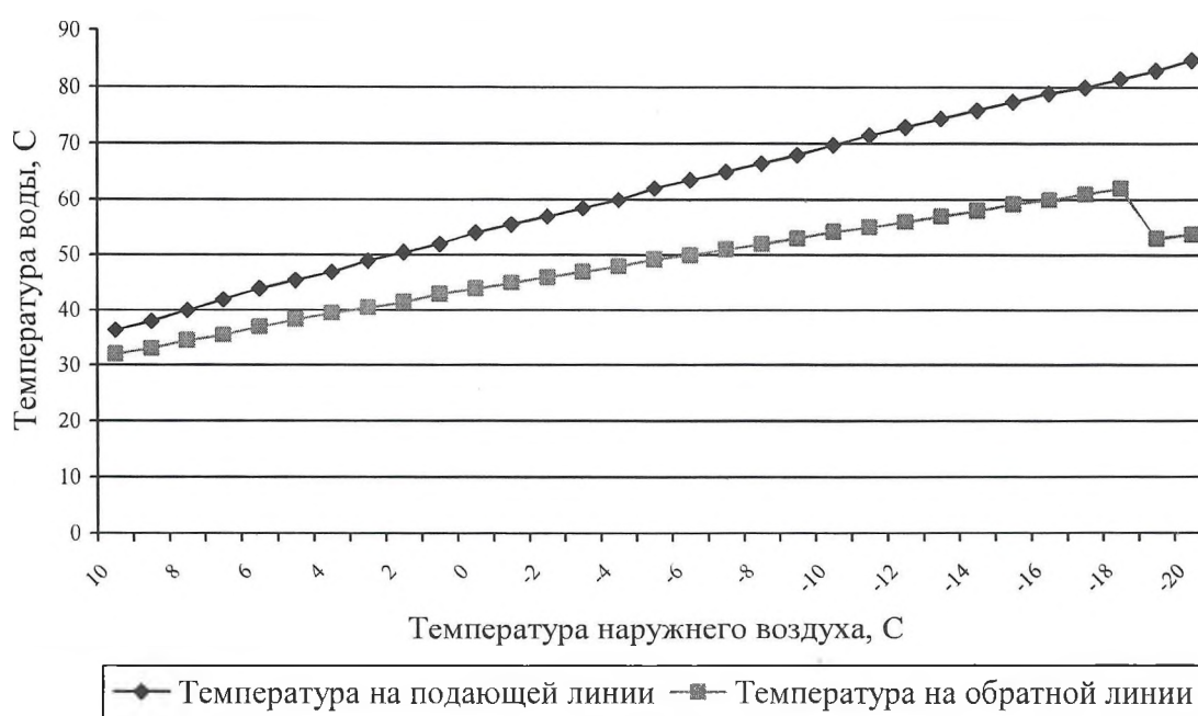
Рисунок 11.1.2.В – График зависимости температуры прямой и обратной сетевой воды от температуры наружного воздуха
